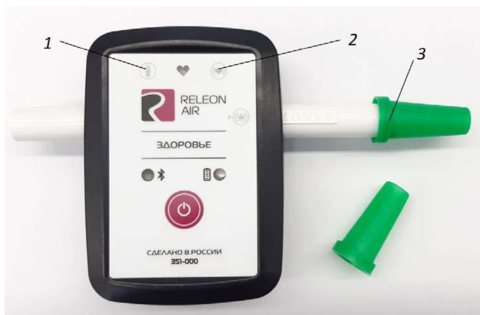
Рис. 3. Мультидатчик по физиологии: 1 — температура тела, 2 — пульс, 3 — частота дыхания (надет съёмный мундштук)
