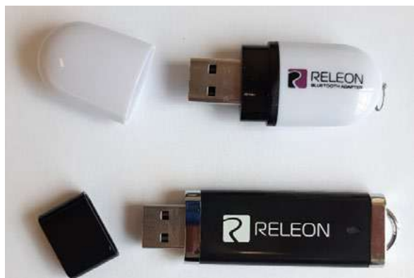
Рис. 3. Общий вид USB-флеш-накопителя (внизу) и Bluetooth-адаптера (вверху)
