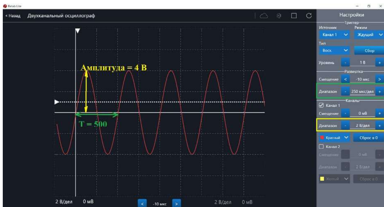
Рис. 42. Определение параметров осциллограммы
