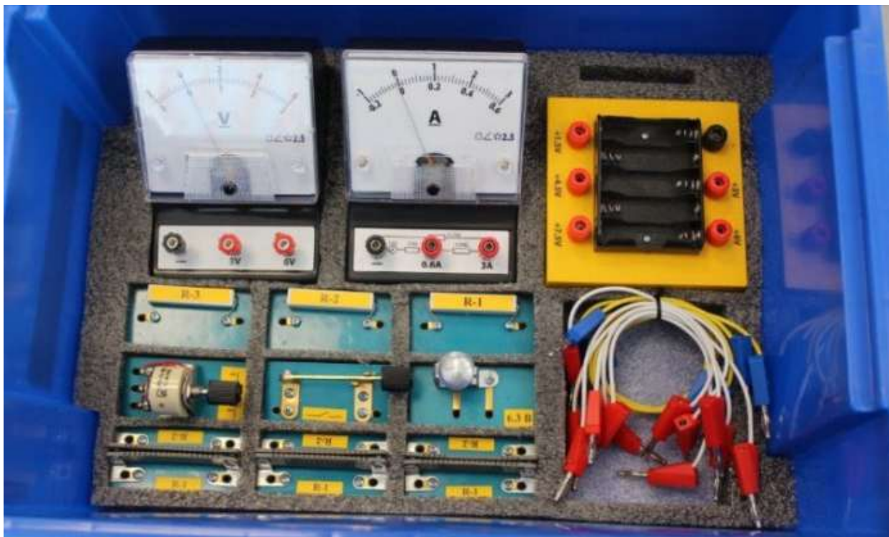
Рис. 2. Оборудование комплекта для проведения экспериментов по электродинамике
