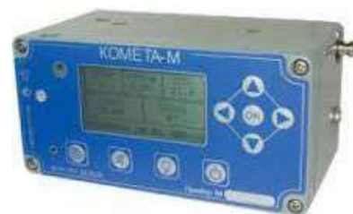
Рис. 51. Вид газоанализатора водорода
